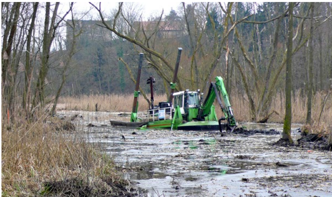
Obr. 7.24 Sací bagr při práci ve starém rameni u Týnce nad Labem. Těžbu komplikují potopené kmeny stromů. Na snímku není vidět výtlačné potrubí těžžené směsi, plovoucí na hladině za zádí plavidla. Potrubí není příliš flexibilní a podle pohybu plavidla musí být přemísťováno pozemním personálem.
