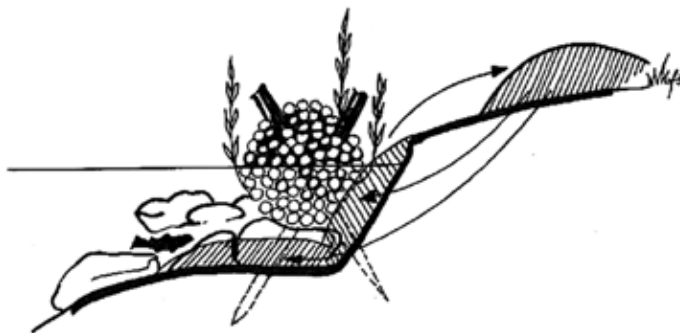
Obr. 6.48 Příčný řez haťovým válcem, zde v podélné pozici v patě břehu, který má být dočasně chráněn před vymíláním. Válec je vložen do rýhy, vyhloubené podél břehu. Je dále stabilizován zatlučenými kůly, balvany a zbylou hlinou z výkopku (kresba: F. Šulgan).
