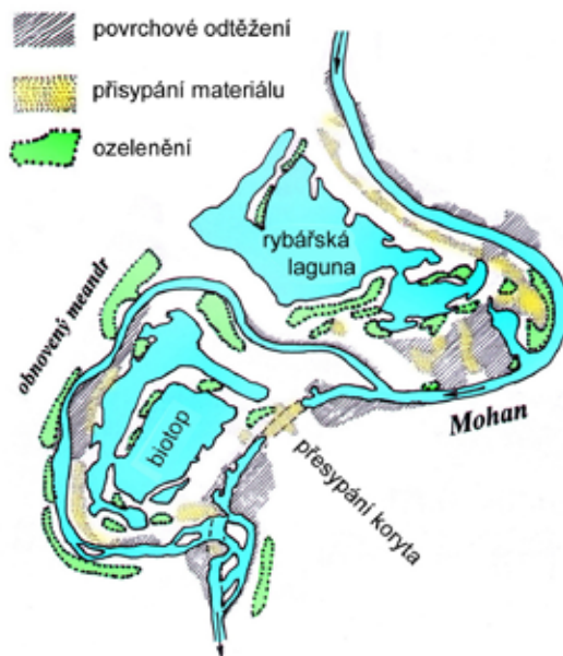
Obr. 5.34 Schéma členité soustavy vodních ploch, vytvořené vhodně cílenou těžbou stavebních písků a štěrků u obce Unterbrunn v nivě bavorského horního (nesplavného) Mohanu. Zhruba desetiletá těžební kampaň začínala kolem roku 2005 a jejími produkty jsou mocný revitalizační meandr Mohanu, „biotopní jezero“ a soustava vodních ploch věnovaná sportovnímu rybářství
