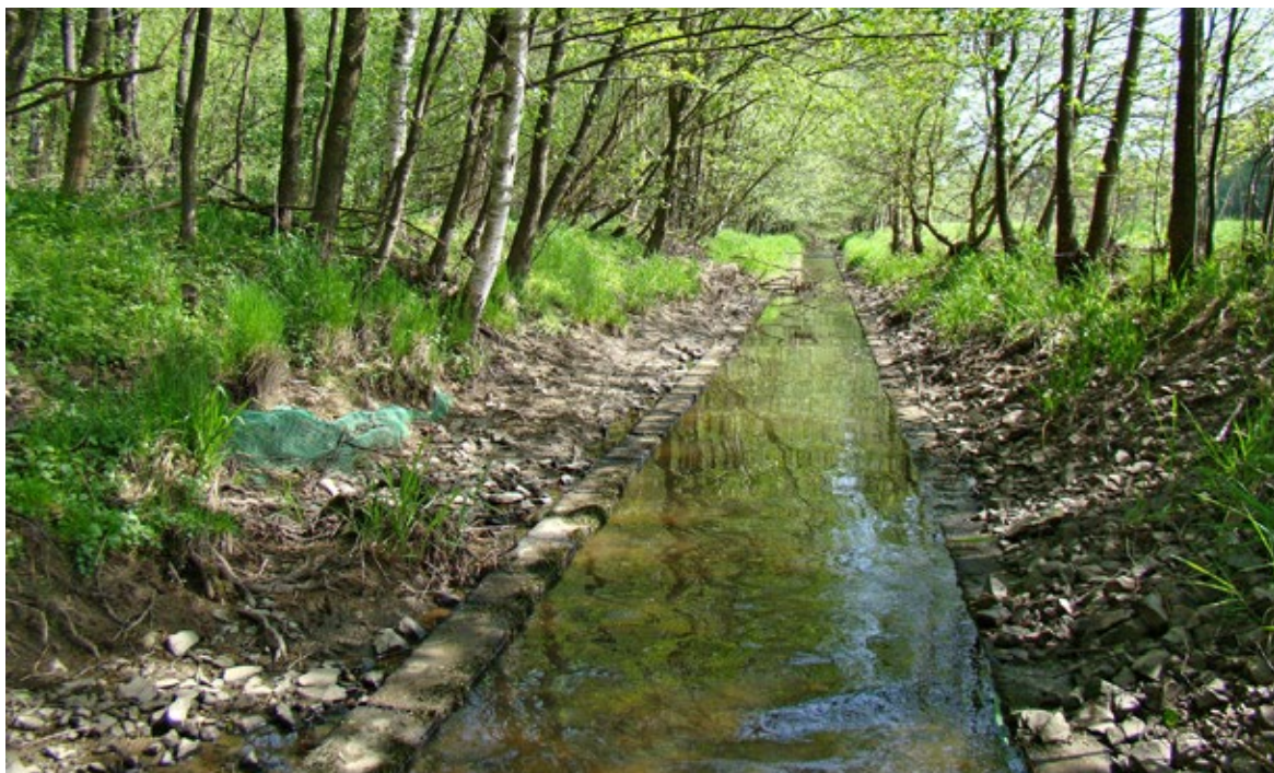
Obr. 1.1 Koryto potoka Slubice před soutokem s Chrudímkou, v loukách daleko od zastavěných území. Napřímené, zkapacitněné a opevněné vegetačními tvárnici, tedy vhodné k revitalizaci. (Foto K. Kujanová)
